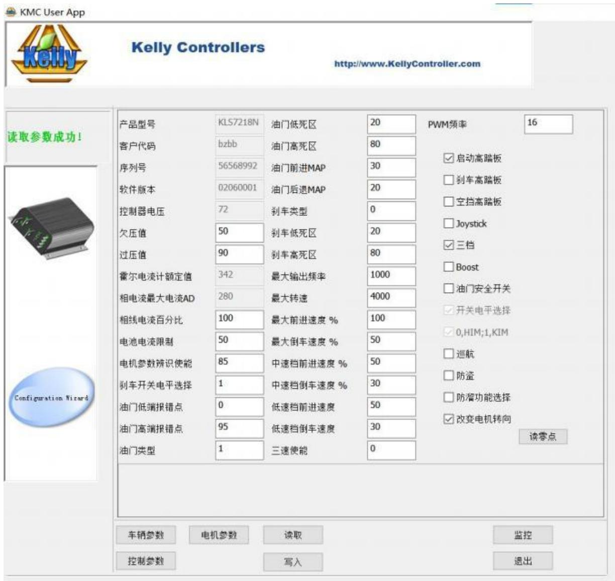
请检查“电机参数辨识使能”项目是否为 **85**。如果“电机参数辨识使能”项目为 **85**，则正确。但客户在开车前仍需要进行识别操作。因为 **85** 表示该控制器在装运前在工厂完成了电机的识别操作。您的电机与控制器供应商的电机不同。
