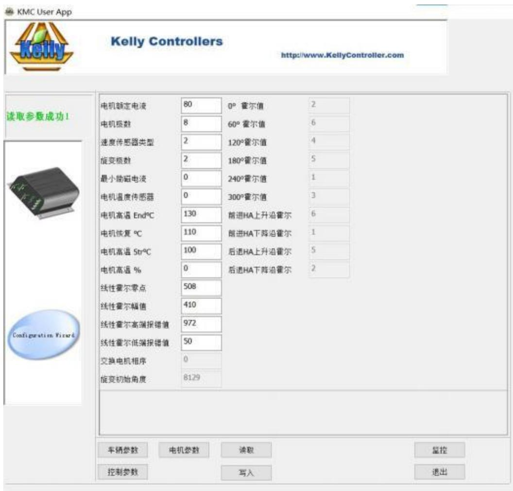
(1)电机标称电流：当控制器在电机空载进行识别相位操作时。如果电机额定功率很高，请将此参数增加到更高的值。否则，请默认将其保持在 80。如果电机功率很低，例如数百瓦，请将此参数降低到较低的值，以匹配低功率电机的识别操作。
