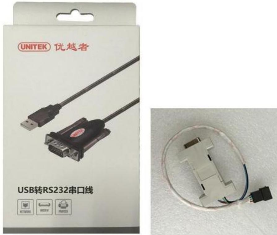
客户还可以使用 Z-TEK USB 到 RS232 电缆和 SM-4A DB9 (RS232) 转换器将控制器连接到 Android 平板电脑。
